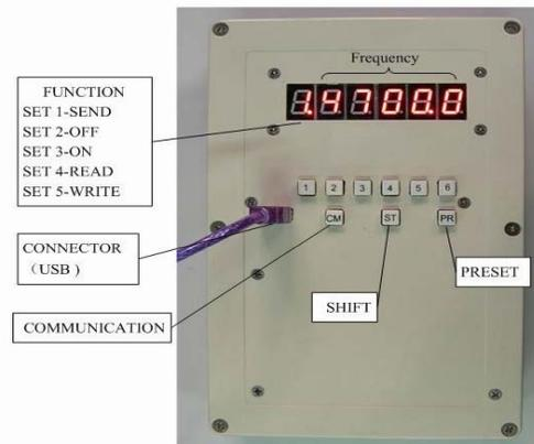
OFDM FREQUENCY BLOCK UP CONVERTER 19.85GHz~20.20GHz
